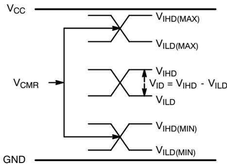
**Figure 8. V<sub>CMR</sub> Diagram**
