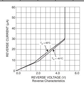
Datasheet of ZRB500A03 - IC VREF SHUNT 5V TO92-3
