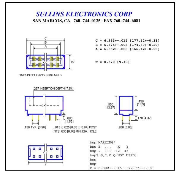
1.0 SPECIFICATIONS FOR A DUAL 43/86 POSITION EDGECARD CONNECTOR
