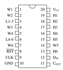
DS1806 20-Pin DIP (300-mil) DS1806S 20-Pin SOIC (300-mil) DS1806E 20-Pin TSSOP (173-mil) See Mech. Drawings Section
