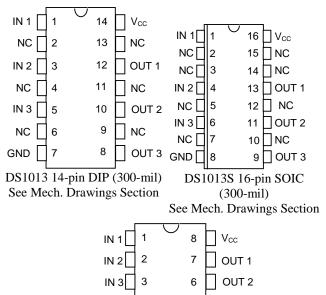
DS1013M 8-pin DIP (300-mil) See Mech. Drawings Section
