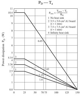
Ambient temperature T<sub>a</sub> (°C)
