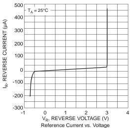
Datasheet of LM4040C25QFTA - IC VREF SHUNT 2.5V SOT23
