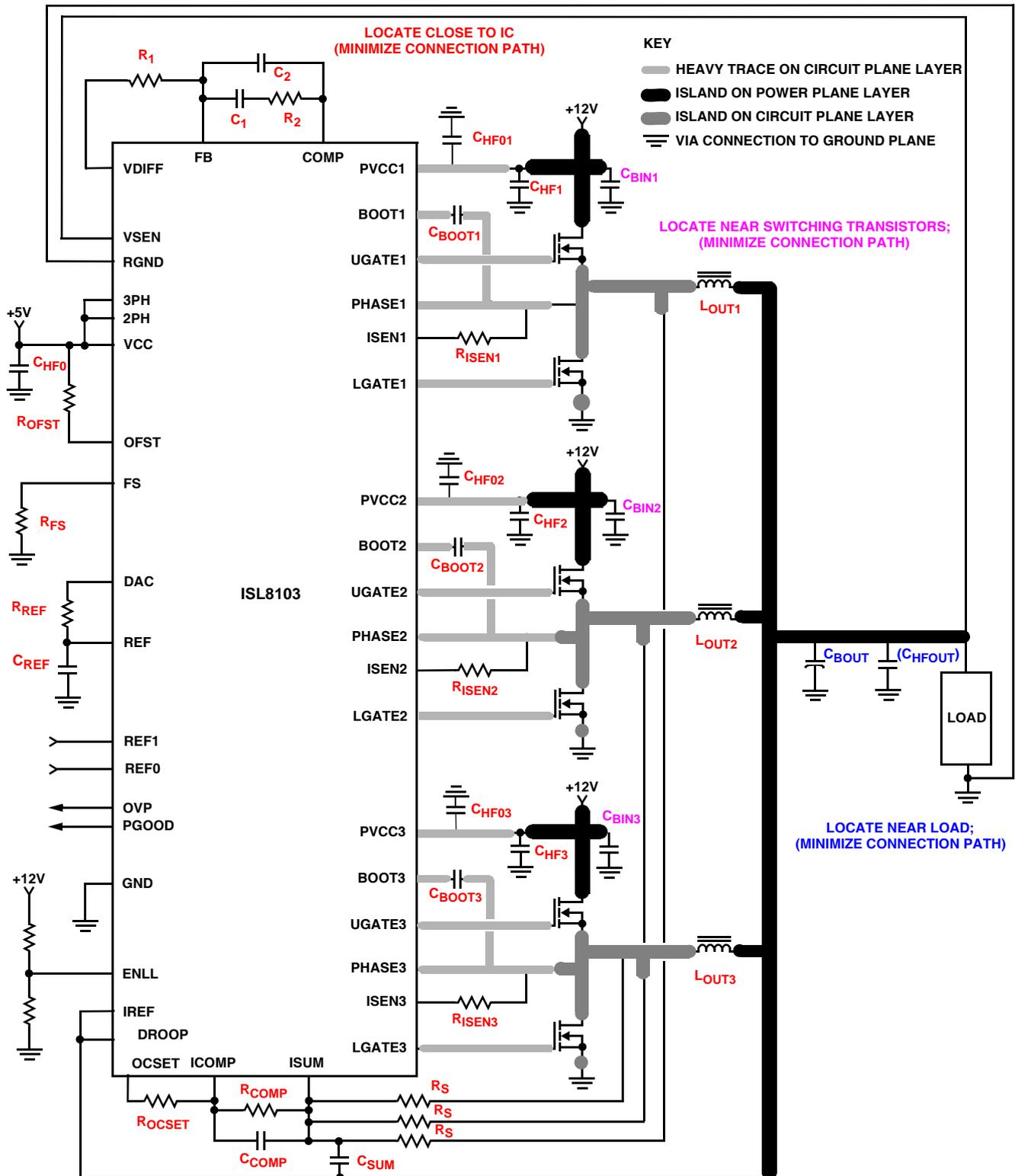
FIGURE 27. PRINTED CIRCUIT BOARD POWER PLANES AND ISLANDS
