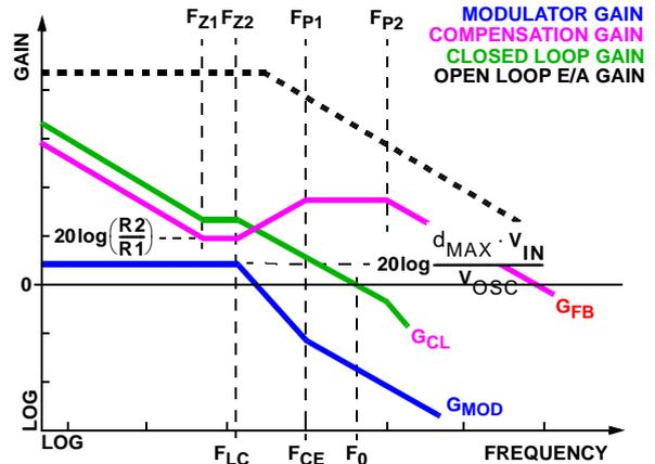
**FIGURE 22. ASYMPTOTIC BODE PLOT OF CONVERTER GAIN**
