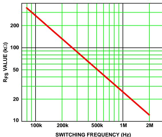
**FIGURE 23. R<sub>FS</sub> vs SWITCHING FREQUENCY**
