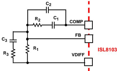
**FIGURE 20. COMPENSATION CONFIGURATION FOR NON-LOAD-LINE REGULATED ISL8103 CIRCUIT**
