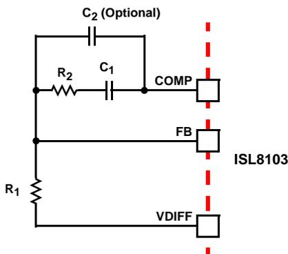
**FIGURE 19. COMPENSATION CONFIGURATION FOR LOAD-LINE REGULATED ISL8103 CIRCUIT**
