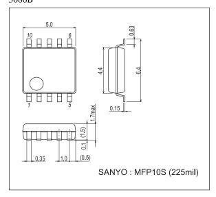
Datasheet of LA4537M-TE-L-E - IC AF PWR AMP 1.5V HDPH MFP10S
