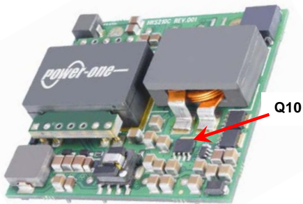
Figure 19. Thermal Reference Q10 (Top side)
