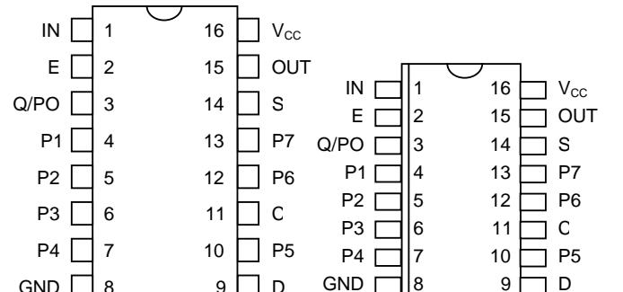
DS1020 16-pin DIP (300-mil) See Mech. Drawings Section
