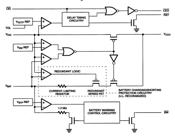
Datasheet of DS1312S-2 - IC CTRLR NV W/BATT MOD 8-SOIC
