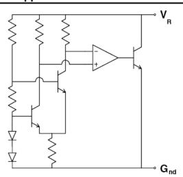
Datasheet of ZRC400F01TA - IC VREF SHUNT 4.096V SOT23
